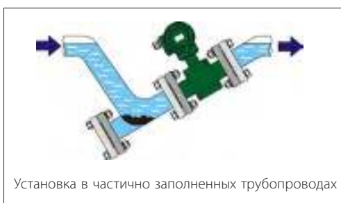
Расходомер устанавливается электронным блоком ВВЕРХ
